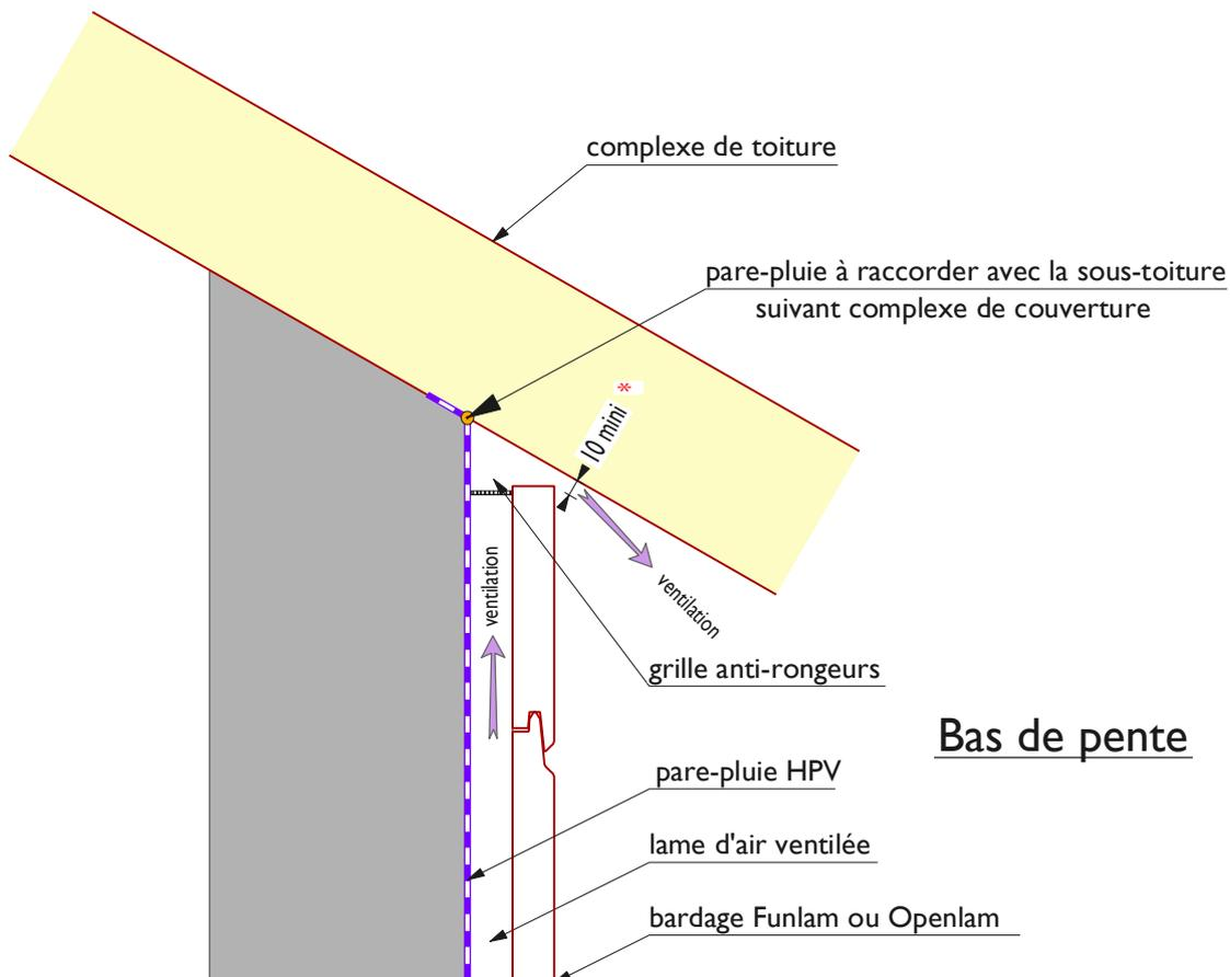
\* entrée basse et sortie haute de ventilation à adapter en fonction de la hauteur du mur (D.T.U. 41.2 § 7.2.4)
