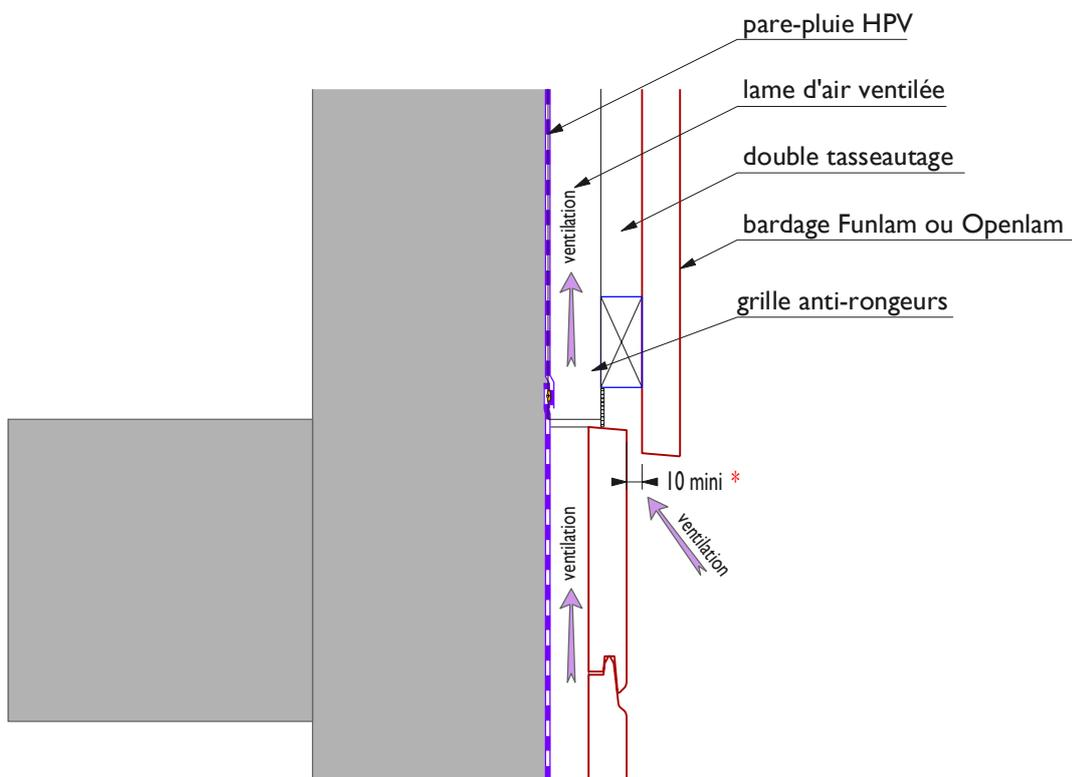
\* entrée basse et sortie haute de ventilation à adapter en fonction de la hauteur du mur (D.T.U. 41.2 § 7.2.4)
