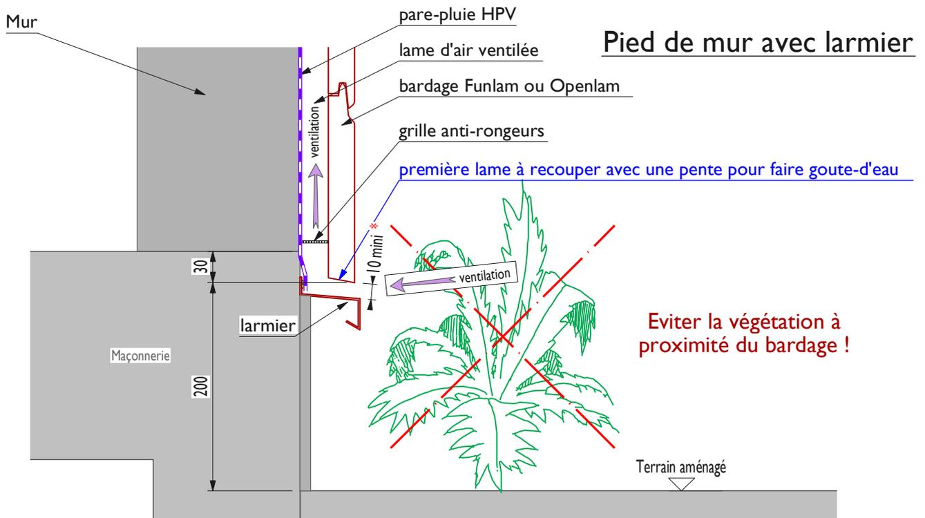
\* entrée basse et sortie haute de ventilation à adapter en fonction de la hauteur du mur (D.T.U. 41.2 § 7.2.4)
