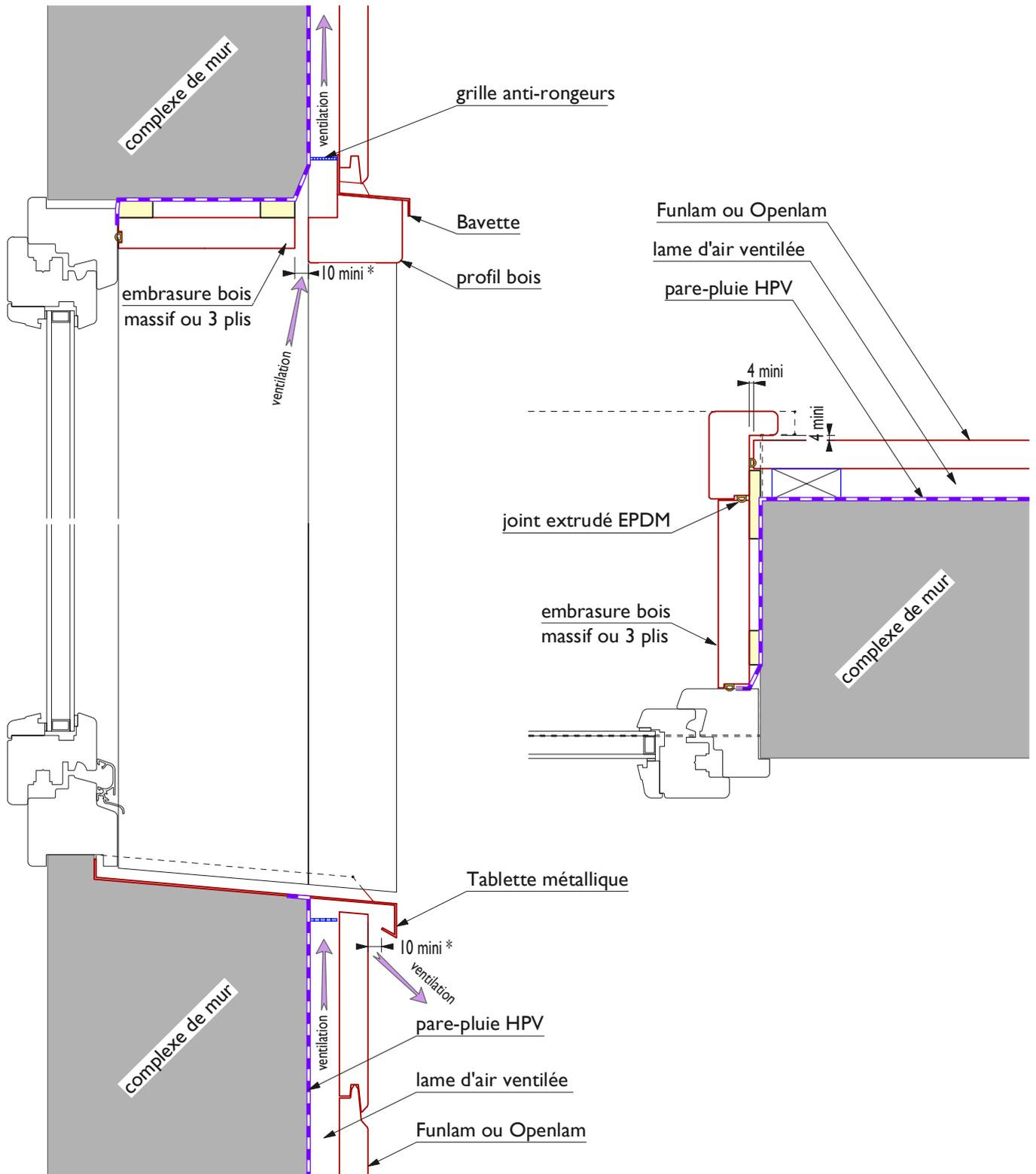
\* entrée basse et sortie haute de ventilation à adapter en fonction de la hauteur du mur (D.T.U. 41.2 § 7.2.4)
