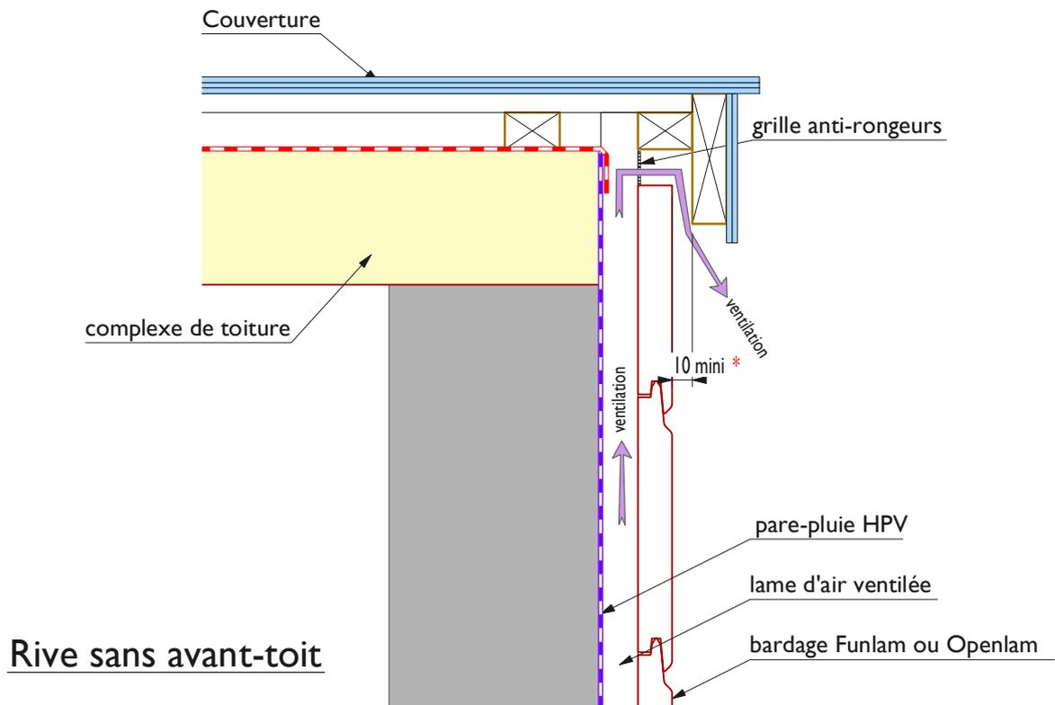
\* entrée basse et sortie haute de ventilation à adapter en fonction de la hauteur du mur (D.T.U. 41.2 § 7.2.4)
